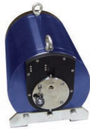
⤴ Гамма-дефектоскоп Exertus Vox 100
