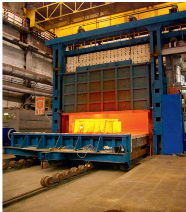
◀ Ширина печи 5,2 м, высота 2,4 м, длина 7,5 м. Максимальная температура +1200 °С
