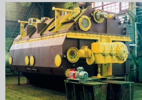
Фильтр барабанный герметизированный типа БГН для процесса депарафинизации на НПЗ
