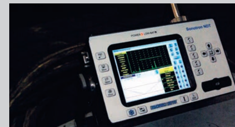
⤴ Isonic 2010 Дефектоскоп с использованием ультразвуково-вых фазированных решеток (УЗФР). Сканирование методом «тандем». Сканирование методом TOFD
