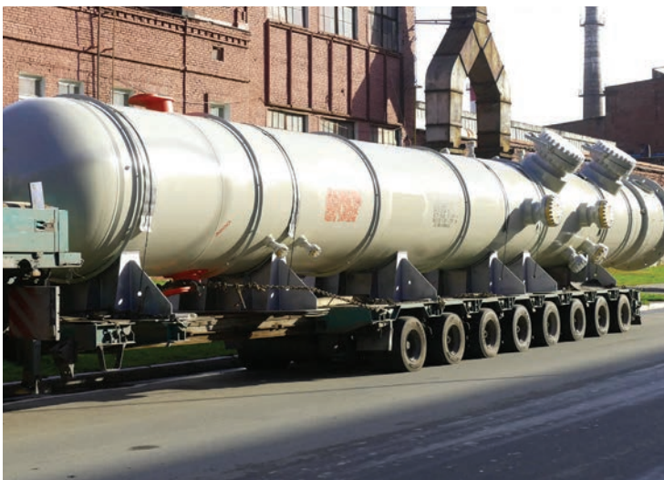
Скруббер для удаления сероводорода из сырья для КУПН
