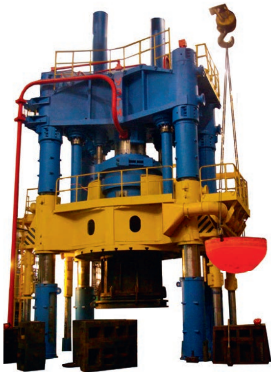
▶ Штамповка днищ различных диаметров для сосудов и аппаратов, изготавливаемых на заводе. Максимальная мощность 6500 т
