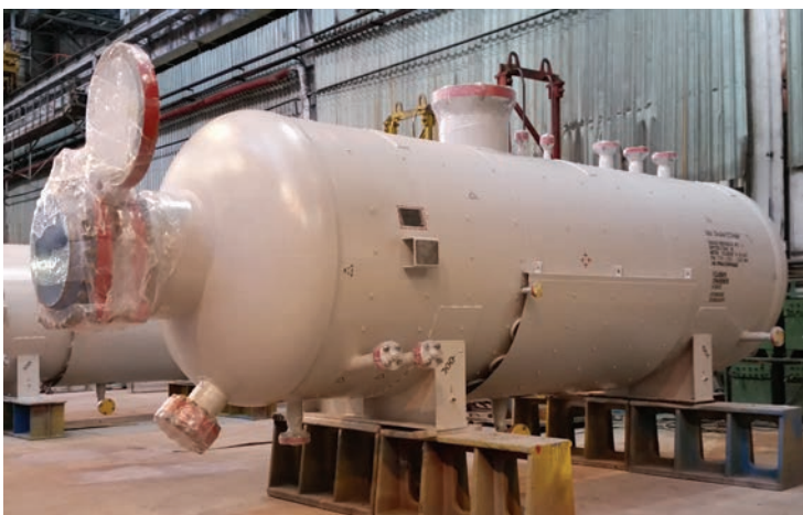
Блок пробкоуловителя 10ПУ-1 масса: 38,3 т
