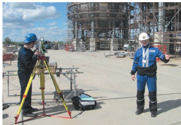
⤴ Тахеометр Leica TDRA 6000 Высокоточный инструмент, осуществляющий геометрические измерения в пространстве и математическую обработку данных
