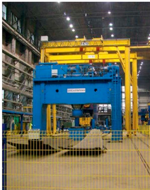
Пресс «Schleifstein». Штамповка элементов шаровых резервуаров. Максимальная толщина 80 мм
