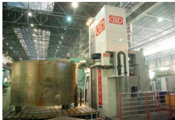
На центре М+АРХ FPT выполняются полу-чистовая и чистовая обработка (точение, растачивание, фрезерование, сверление) элементов деталей корпусного типа
