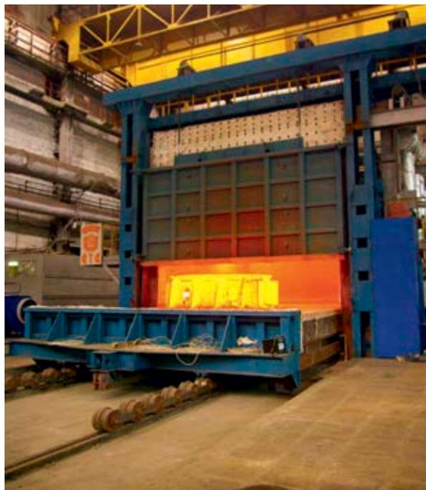
⬆ Ширина печи 5,2 м, высота - 2,4 м, длина 7,5 м. Максимальная температура +1200°C
