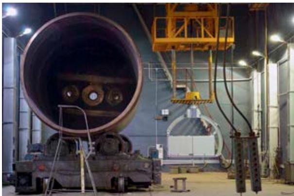
⤴ Линейный ускоритель электронов УЭЛ-6-Д
