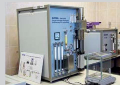
➤ Анализатор Eltra ONH 2000 с модулем Eltra H500 для определения содержания диффузионно-подвижного водорода в наплавленном металле. Анализатор для определения содержания углерода и серы ELTRA CS 2000
