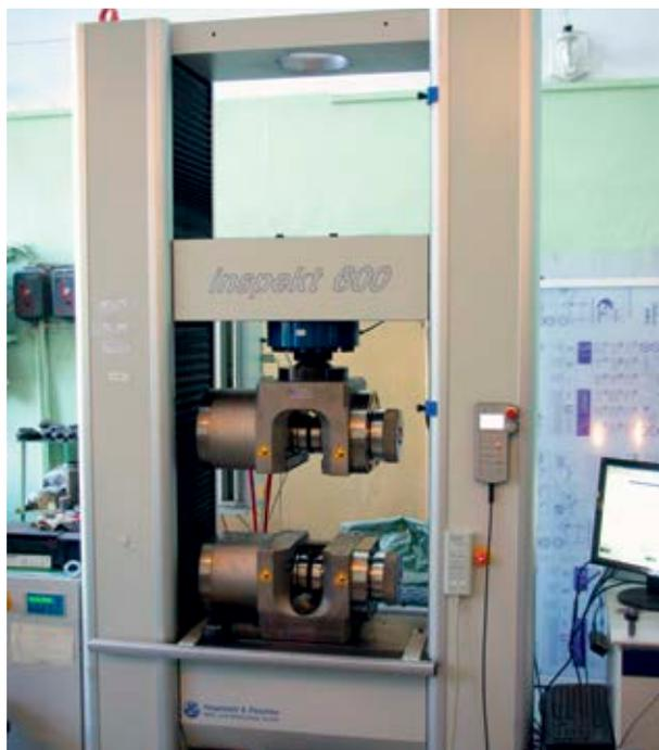
➤ Универсальные испытательные машины INSPEKT 600 и INSPEKT 100 с высокотемпературной печью до 1200°C для определения механических характеристик
