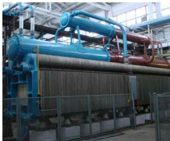
Для получения водорода и кислорода методом электрического разложения воды.
