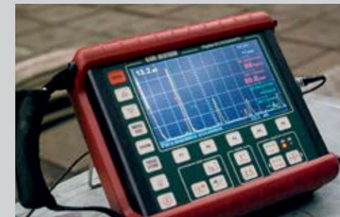
⤴ Цифровой ультразвуковой дефектоскоп ECHOGRAPH 1090
