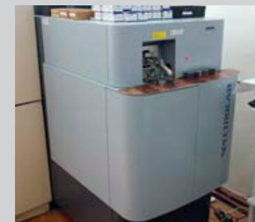
➤ Стационарный оптико-эмиссионный спектрометр Spectrolab M11
